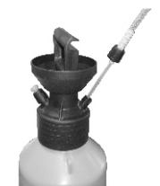
3. Überprüfen Sie, ob der O-Ring im Kolben eingesetzt wurde, dann können Sie die Spruhlanze montieren. Vor der Montage der Spruhlanze ist der O-Ring in den Kolben einzusetzen.
